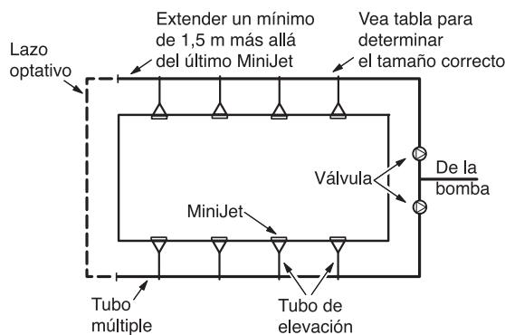
3. Si los MiniJets se encuentran alineados para proyectar chorros de agua a igual distancia, corte todos los tubos de elevación al mismo tamaño. Si los MiniJets no se han colocado en líneas paralelas a la orilla de la piscina, ajuste las válvulas por separado.
